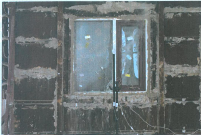
图3 耐火完整性试验中样品状态图
