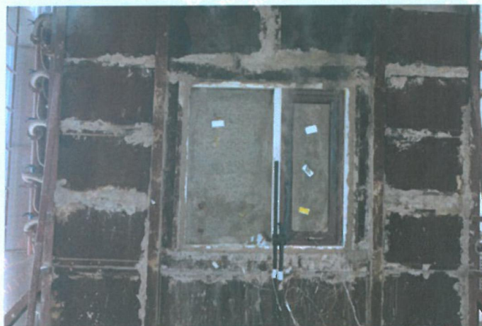
图4 耐火完整性试验30分钟样品未失去完整性状态图
