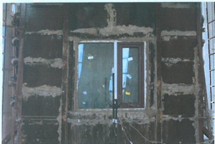
图2 耐火完整性试验前样品状态图
