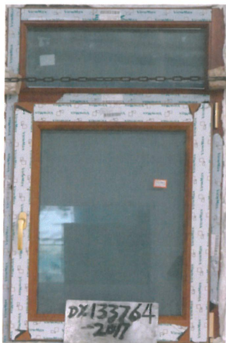
照片一 耐火试验前试件情况
