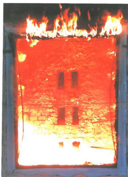
照片 2 耐火试验结束时试件情况
