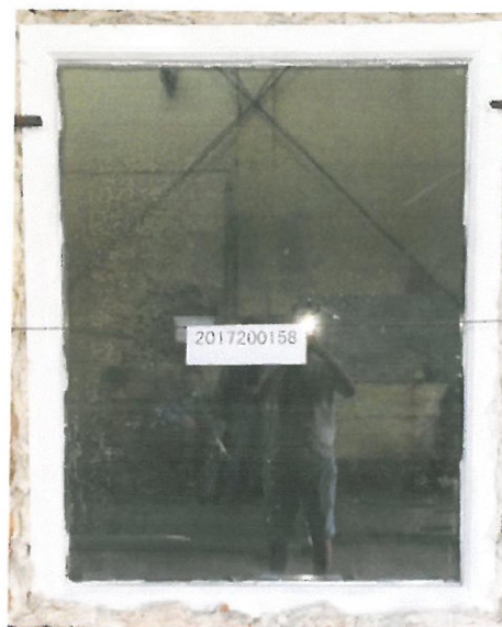
照片 1 耐火试验前试件情况
