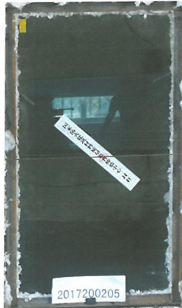
照片 1 耐火试验前试件情况
