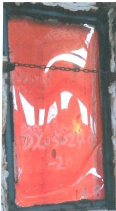
照片二 耐火试验结束时试件情况 2017-3-8 120min
