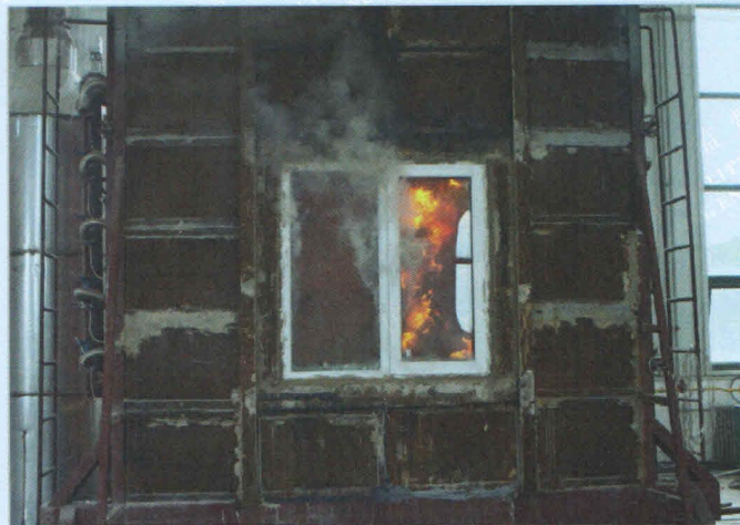
图3 耐火完整性试验中样品状态图
