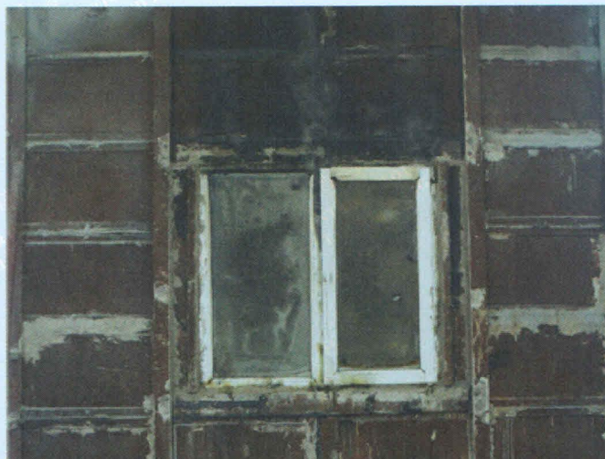
图4 耐火完整性试验结束样品未失去完整性状态图
