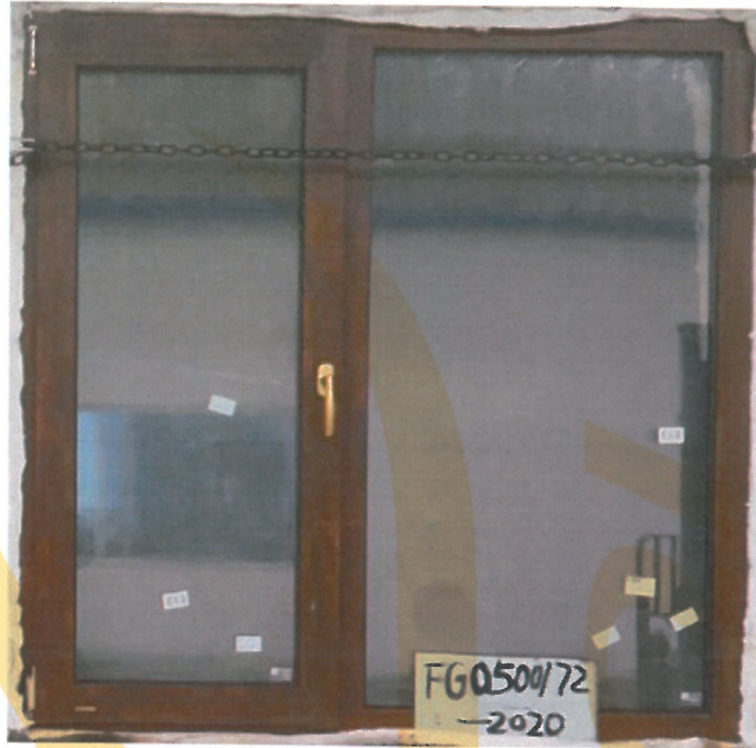
照片一 耐火试验前试件情况
