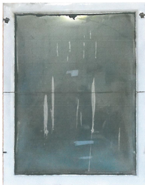
照片 2 耐火试验结束时试件情况
